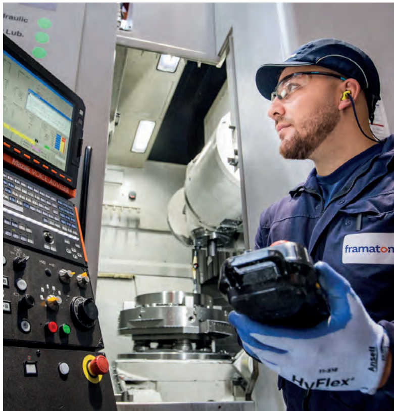
Framatome Jeumont - Contrôle d'un composant de pompe primaire
