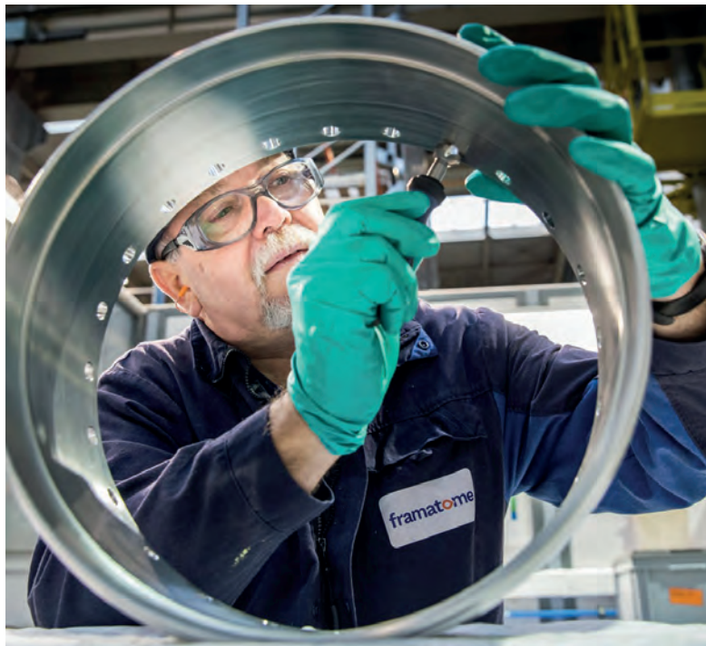
Framatome Jeumont Ajustage joint hydrodynamique de pompe primaire
