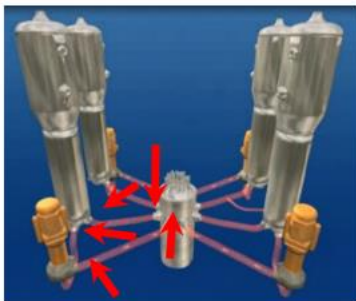
Ruptures en différents points d'une boucle primaire
