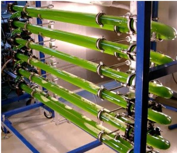
Réacteur de bio-production d'hydrogène
