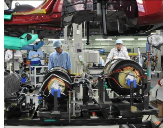
Intégration de réservoirs haute pression (700 bar, type IV) dans la Toyota Mirai
